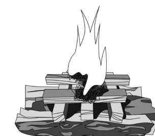
FIG. 4.7 Module de mise à feu en train de brûler sur la pile de bûches
